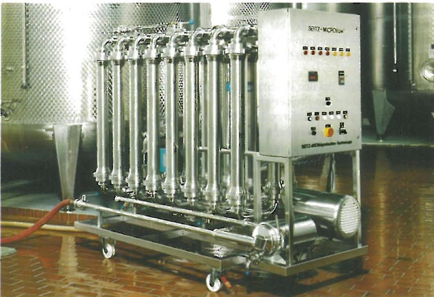
Abb. 7: Bei dem heute zur Getränkefiltration üblichem Verfahren fallen jährlich etwa 150.000 t Naß-Kieselgur mit Sondermüllcharakter an. Mit BMFT-Förderung wird die Cross-Flow-Mikrofiltrationstechnologie unter Verwendung verschiedener Membrantypen entwickelt. Bei erfolgreichem Abschluß des Vorhabens kann die Kieselgurfiltration weitestgehend ersetzt werden (Foto Seitz/Heisterkamp).
