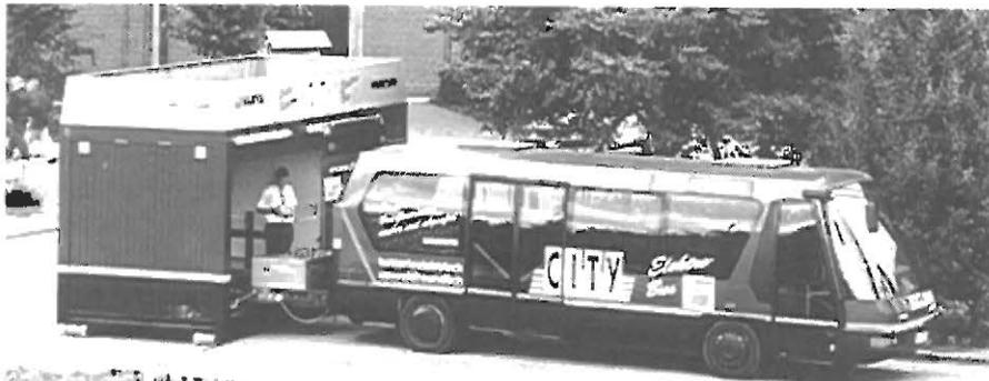
Abb. 8: Neoplan MIC Metroliner, Leichtbau-Elektrobus mit Kohlefaser-Karosserie und Schwungradzusatzspeicher.
