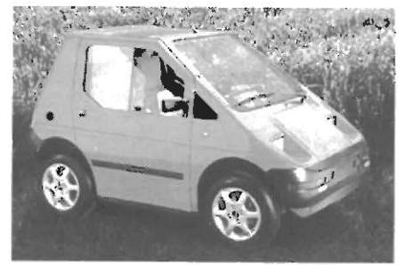
Abb. 9: KEWET City-Jet, crashgetestetes zweisitziges Fahrzeug im Purpose-Design mit verzinktem Stahlrohrrahmen.
