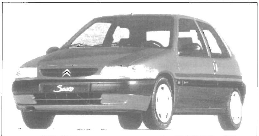
Abb. 2: Citroën Saxo, Fahrzeug im Conversion-Design, als 2- und 4-Sitzer erhältlich, serienmäßig mit Nickel-Cadmium-Batterien.
